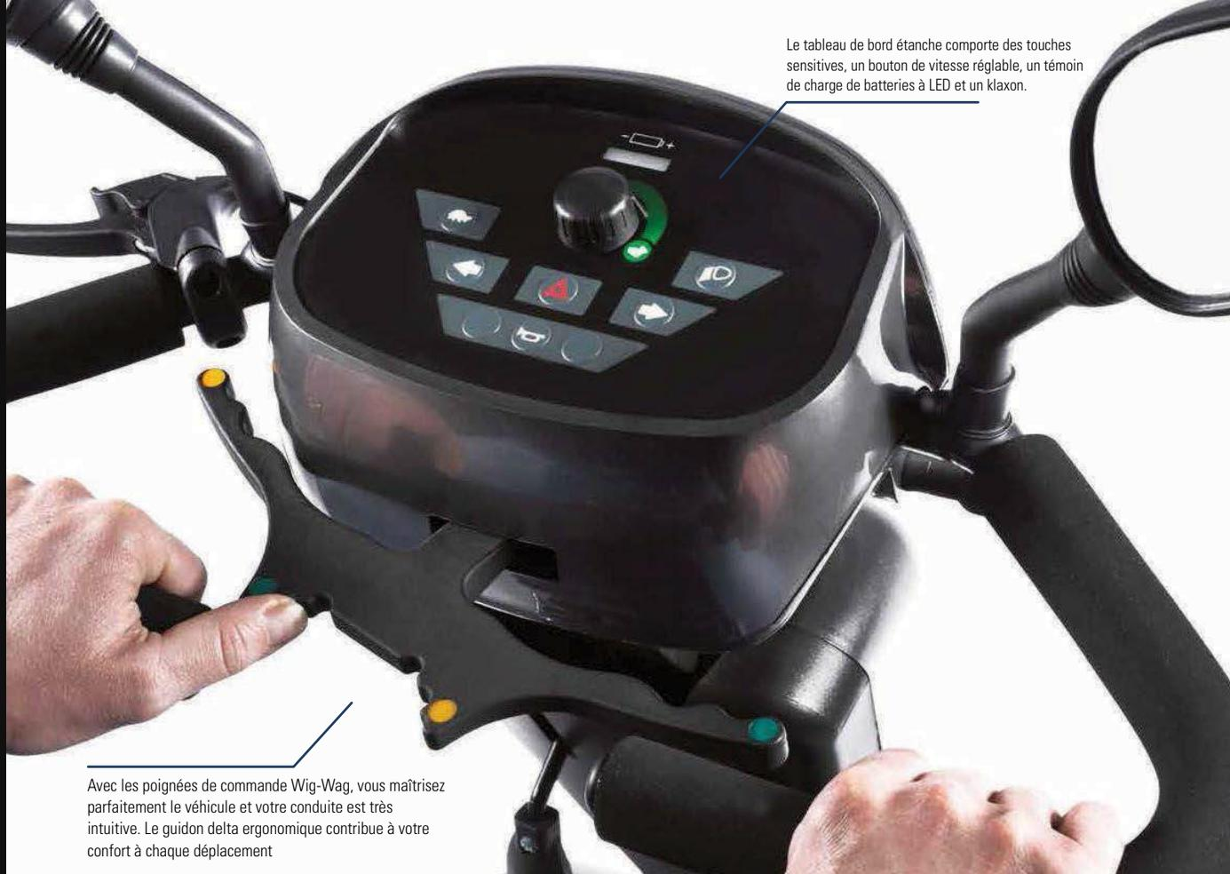
Le tableau de bord étanche comporte des touches sensibles, un bouton de vitesse réglable, un témoin de charge de batteries à LED et un klaxon.
